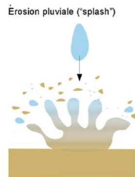
Figure 276 : Schéma de l'effet "splash" (Guide AFB relatif à la protection des milieux aquatiques en phase chantier)
